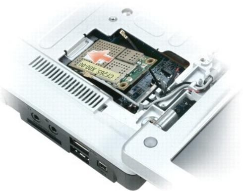
⚠ **AVISO:** Para evitar dañar la minitarjeta, no coloque nunca cables debajo de la tarjeta.
