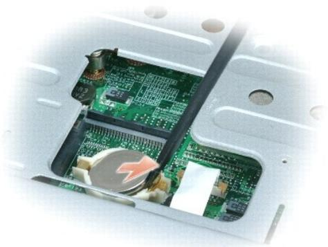
Cuando vuelva a colocar la batería, insértela en un ángulo de 30 grados, por debajo del gancho, con el lado positivo (identificado por un símbolo de suma [+]) hacia arriba y, a continuación, presione sobre ella para colocarla en su sitio.
